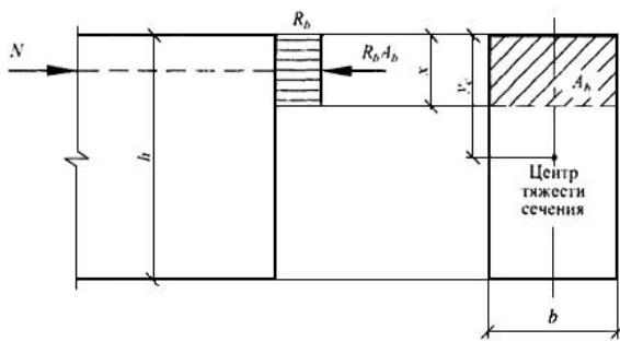
**Рисунок 7.1 - Схема усилий и эпюра напряжений в сечении, нормальном к продольной оси внеклентренно сжатого бетонного элемента, рассчитываемого по прочности без учета сопротивления бетона растянутой зоны**
