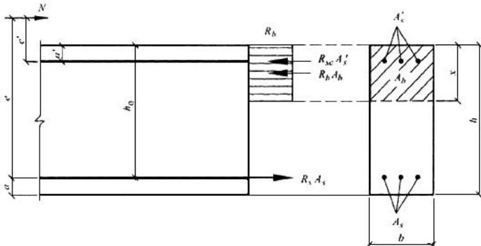
Рисунок 8.3 - Схема усилий и эпюра напряжений в сечении, нормальном к продольной оси внеклентренно сжатого железобетонного элемента, при расчете его по прочности
