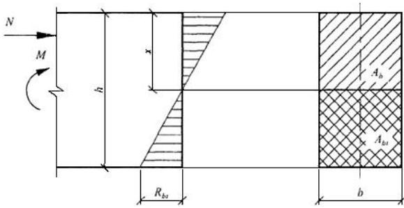
Рисунок 7.2 - Схема усилий и эпюра напряжений в сечении, нормальном к продольной оси изгибающегося (внеклентренно сжатого) бетонного элемента, рассчитываемого по прочности с учетом сопротивления бетона растянутой зоны
