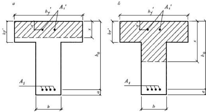
Рисунок 8.2 - Положение границы сжатой зоны в сечении изгибающегося железобетонного элемента
