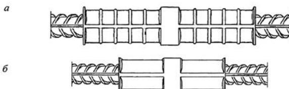
Рисунок Н.1 - Опрессованный стык построочного изготовления, произведенный на мобильном оборудовании многократным поперечным деформированием соединительной муфты с промежутками (а) и без промежутков (б)
