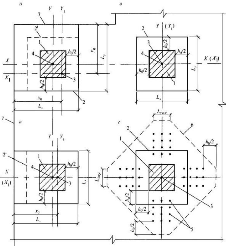
*a* - площадка приложения нагрузки внутри плоского элемента; *b*, *c* - то же, у края плоского элемента; *g* - при крестообразном расположении поперечной арматуры.
