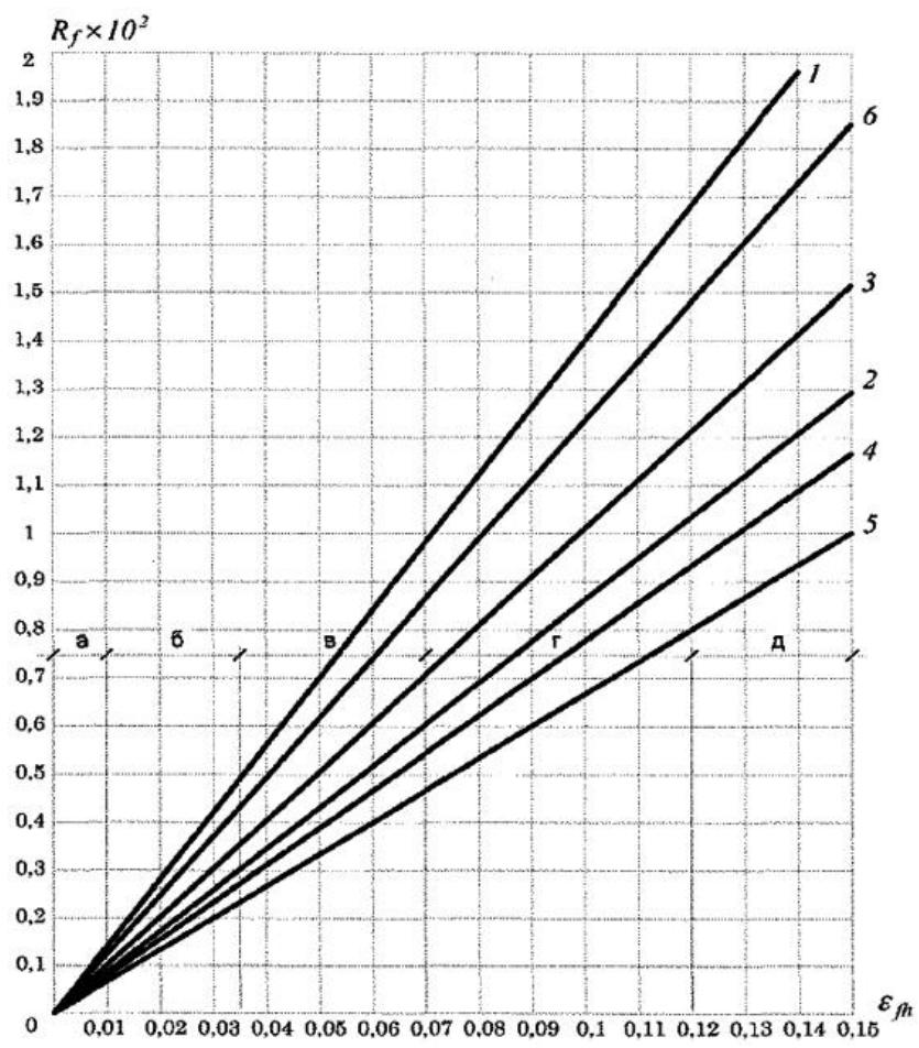
1, 2 - супеси; 3 - суглинки; 4 - суглинки с  $0,07 < I_p \leq 0,13$ ; 5 - суглинки с  $0,13 < I_p \leq 0,17$ ; 6 - глины (в грунтах 2, 4 и 5 содержание пылеватых частиц размером 0,05-0,005 мм составляет более 50% по массе);
