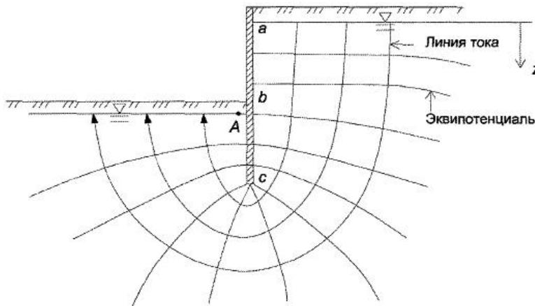
**Рисунок 9.3 - Фильтрация в котлован при несовершенной ПФЗ**
